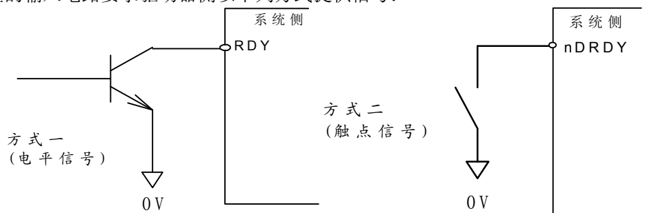
图 2-15 驱动侧提供的信号电路
